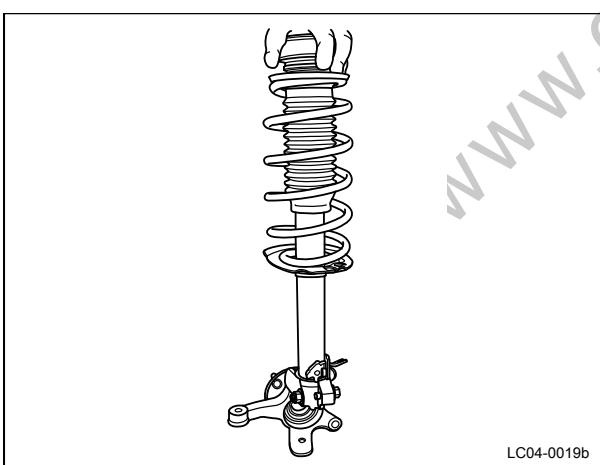
3 安装前支柱总成连同转向节至车身。
