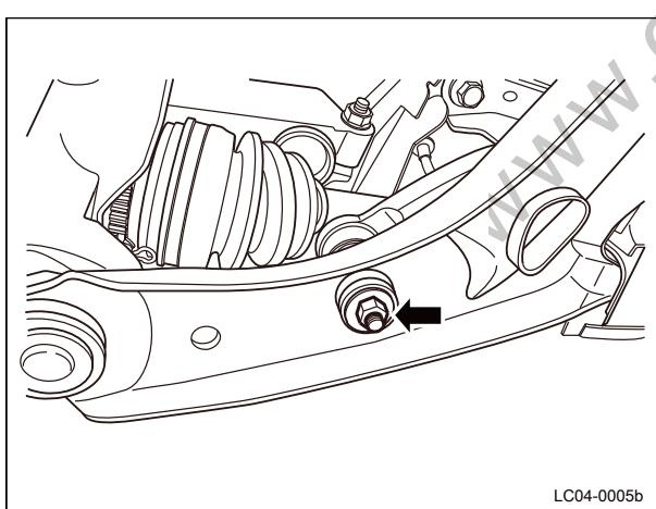
4 安装并紧固稳定连接杆与下摆臂连接螺栓。
