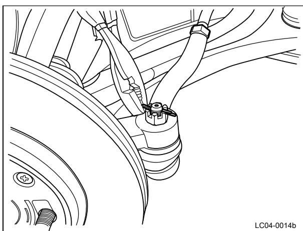
10 安装并紧固转向横拉杆球头固定螺母并使用新的锁止销。
