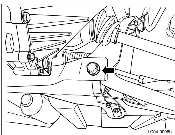
3 安装并紧固下摆臂至副车架固定螺栓（内侧）。
