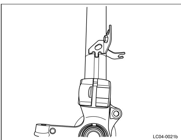
2 使用橡皮锤敲击前支柱总成，使其准确装入至转向节。
