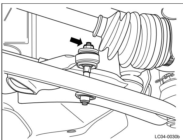
2 安装稳定连接杆至稳定杆，紧固固定螺母。
