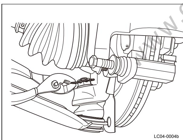
11 安装并紧固下摆臂球头固定螺母并使用新的锁止销。
