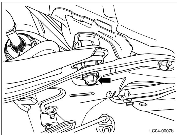
2 安装并紧固下摆臂至副车架固定螺栓（外侧）。
