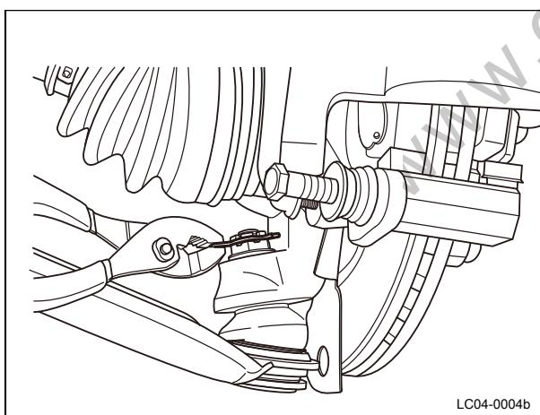
3 安装并紧固下摆臂球头固定螺母，并安装新的锁止销。
