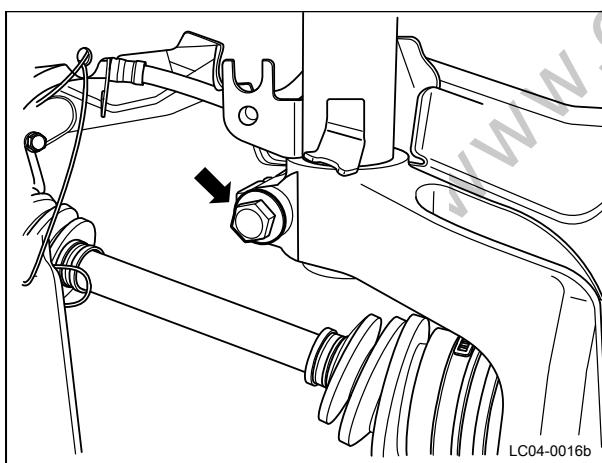
7 安装并紧固转向节和前支柱总成连接螺栓和螺母。
