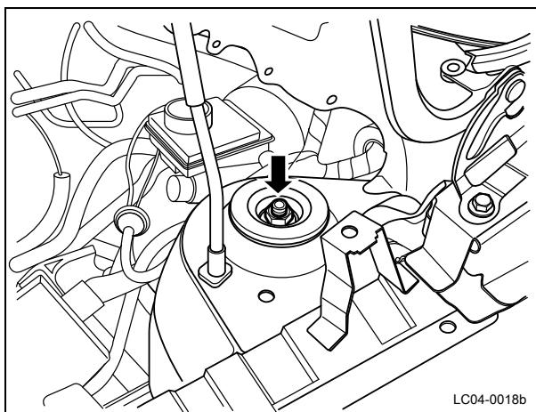
4 安装并紧固前支柱总成固定螺母。
