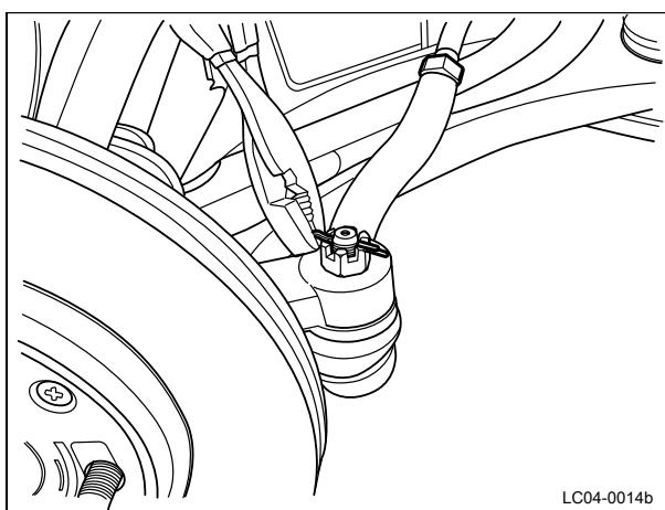
6 拆下转向横拉杆球头锁止销和固定螺母并脱开球头。
