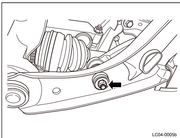
1 安装稳定连接杆至下摆臂，紧固固定螺母。
