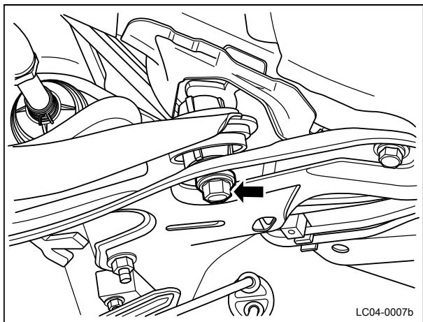
7 拆下下摆臂至副车架固定螺栓（外侧）。
