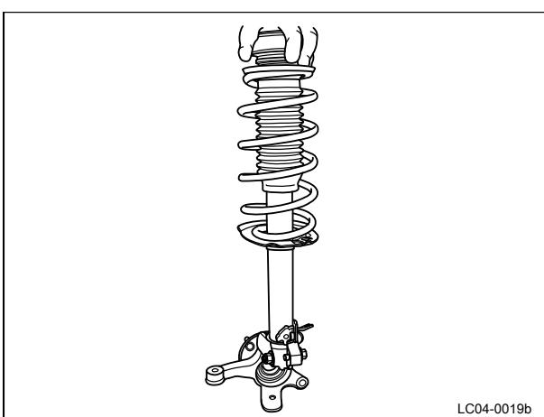
14 将前支柱总成连同转向节一起拆下。
